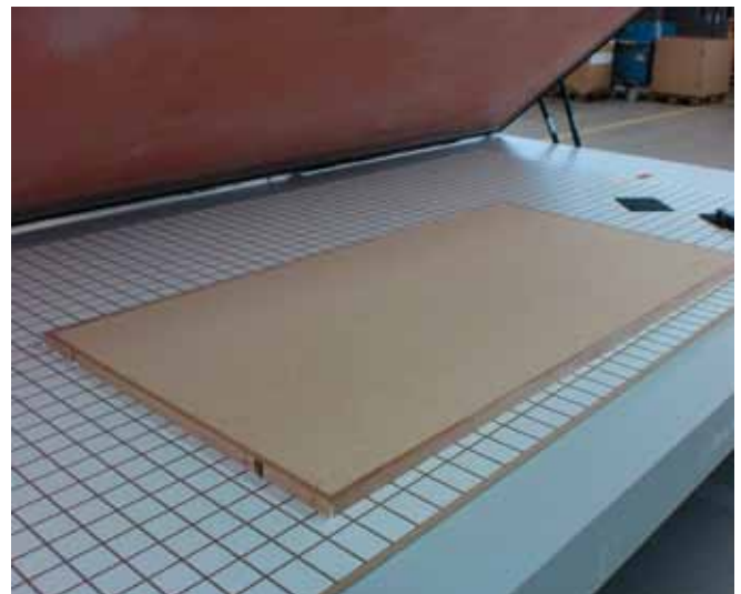
Qualität und Ökologie auf einem Nenner: Ein Gesamtpressdruck von über 9 Tonnen/m 2 ermöglicht schnelle und feste Verleimungen bereits bei Zimmertemperatur.
