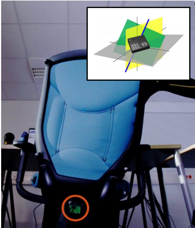
Abbildung 6: Position des Lage-Sensors unter dem Bürostuhl und grafische Darstellung der Messebenen
